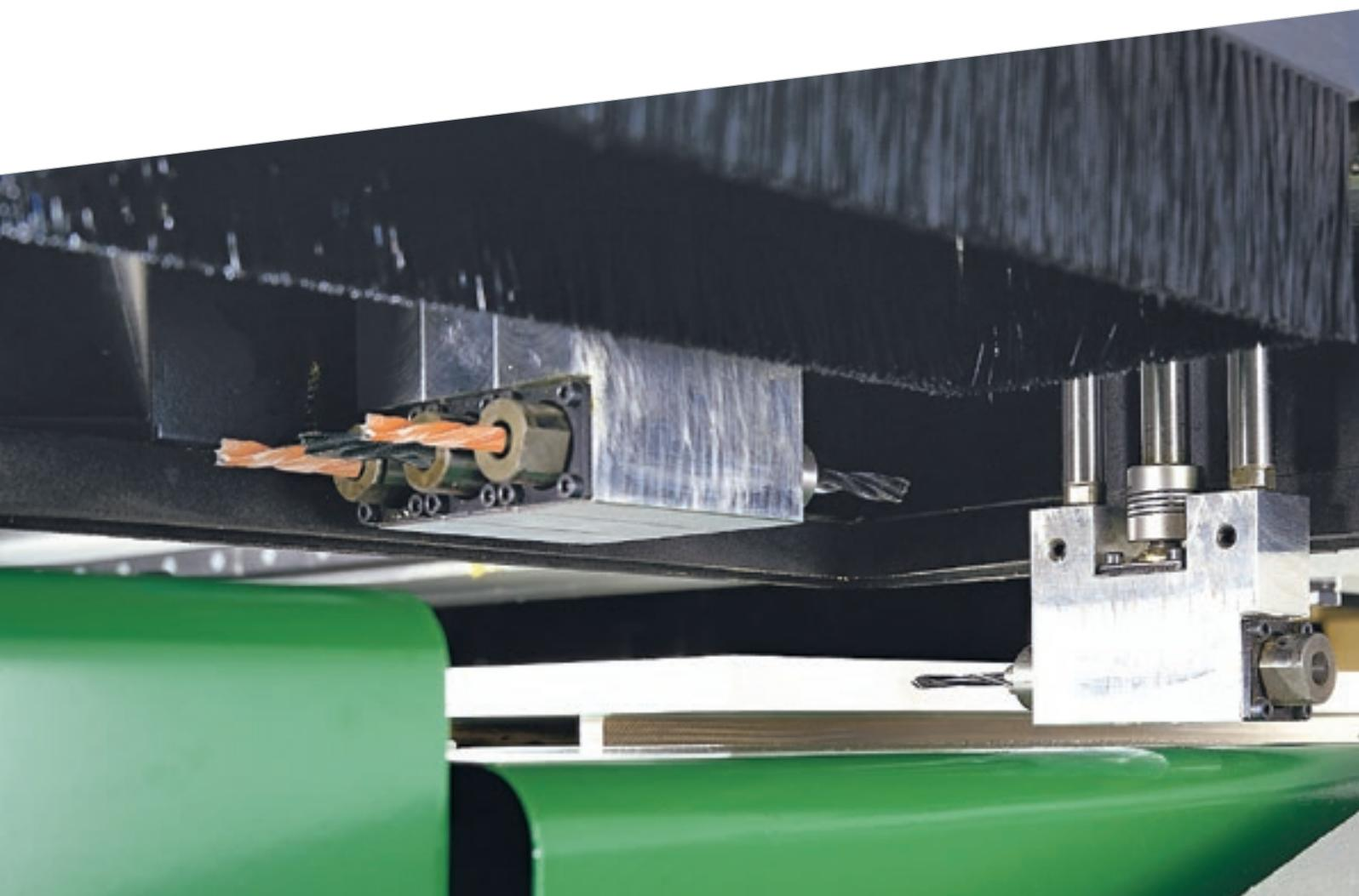
O sistema de batida retrátil permite total acessibilidade da parte frontal do painel.
